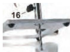
W tym celu należy poluzować śrubę (16) w statywie, przechylić mikroskop w pożądane położenie i ponownie dokręcić śrubę. Ze słupa statywu wystaje metalowy sztyft, który służy do oparcia mikroskopu na Twoim stanowisku roboczym.
