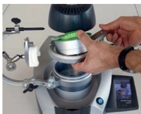
11. Poluzuj pierścień zaciskowy, wyjmij pojemnik Occluform razem z folią
