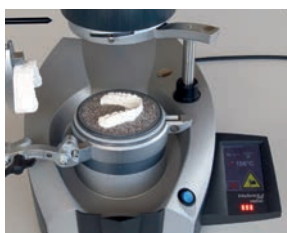
8. Uwaga , rozpoczyna się automatyczny proces formowania wgłębnego. Niebezpieczeństwo zmiążdżenia!
