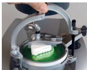
10. Zamknij Occluform-3 do oporu i poczekaj, aż zakończy się czas schładzania
