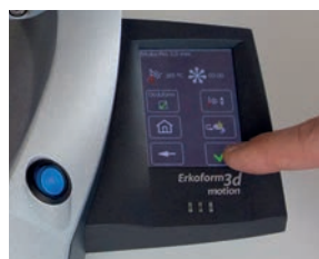
6. Dalej, formowanie wgłębne*, przesunij uchwyt na folię do momentu zakleszczenia(!)...
