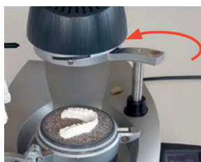
7. ... pod promiennik. Proces nagrzewania zostaje uruchomiony.
