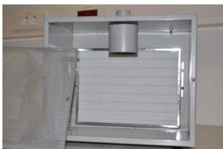
4. Afloje y retire luego los dos tornillos Philips de la chapa perforada situada dentro del aspirador.
