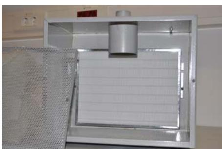
1. Dévissez les deux écrous moletés sur le couvercle de maintenance.
