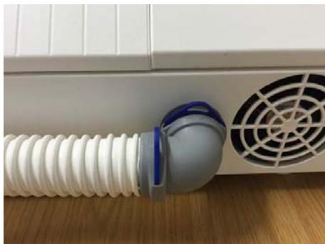
1. Conecte un extremo de la manguera de aspiración en el punto de conexión de la aspiración. El punto de conexión se encuentra en la parte superior, junto al panel de mando con el regulador de la potencia de aspiración.
