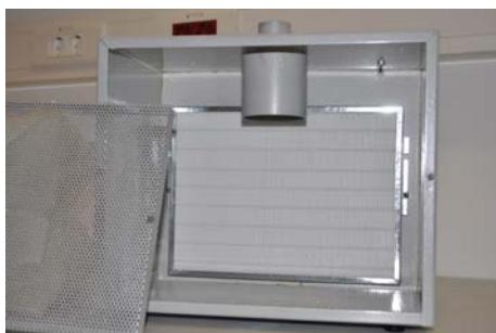
1. Schrauben Sie die beiden Rändelmuttern des Wartungsdeckels ab.
