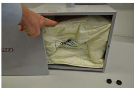
1. Desatornille las dos tuercas moleteadas de la tapa de mantenimiento.
